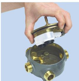
Après avoir retiré manette, capot et vis inox (conserver précieusement les vis inox afin de remonter la cartouche à l'endroit avec les vis inox, ne surtout pas utiliser les vis du kit de rinçage), sortir l'ensemble tampon/cartouche de son logement.
