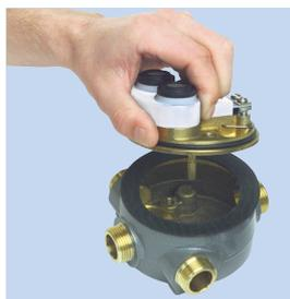
Placer l'ensemble tampon/cartouche à l'envers sur le mitigeur et le joint plat.
